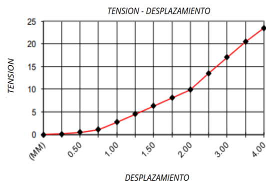
Figura 19. Curva tensión (kgf/cm²) vs. desplazamiento axial (mm). (TecnoSuelo)
