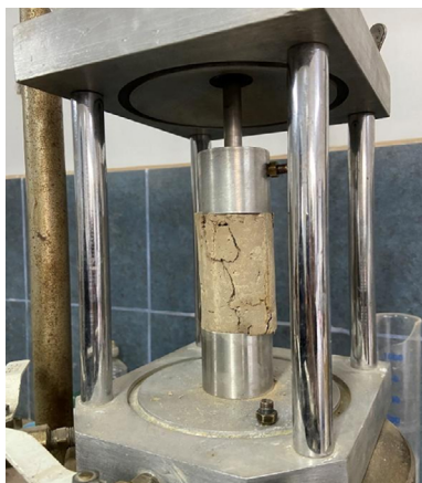
Figura 15. Ejecución de ensayo de compresión simple en empresa TecnoSuelo
